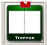
Wählen Sie die Funktion **Trennen** aus. Linke und rechte Seite der Vorlage werden gleichzeitig gescannt, aber als getrennte Bilder abgelegt.
