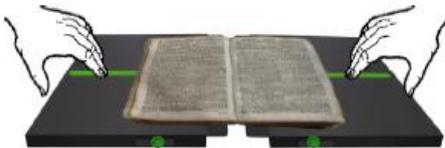
Zum Auslösen des Scanvorganges betätigen Sie bitte die grüne Auslöseleiste auf der Vorlagenfläche.
