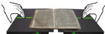
Zum Auslösen des Scanvorganges betätigen Sie bitte die grüne Auslöseleiste auf der Vorlagenfläche und bestätigen Sie danach die Urheberrechtsbestimmungen.
